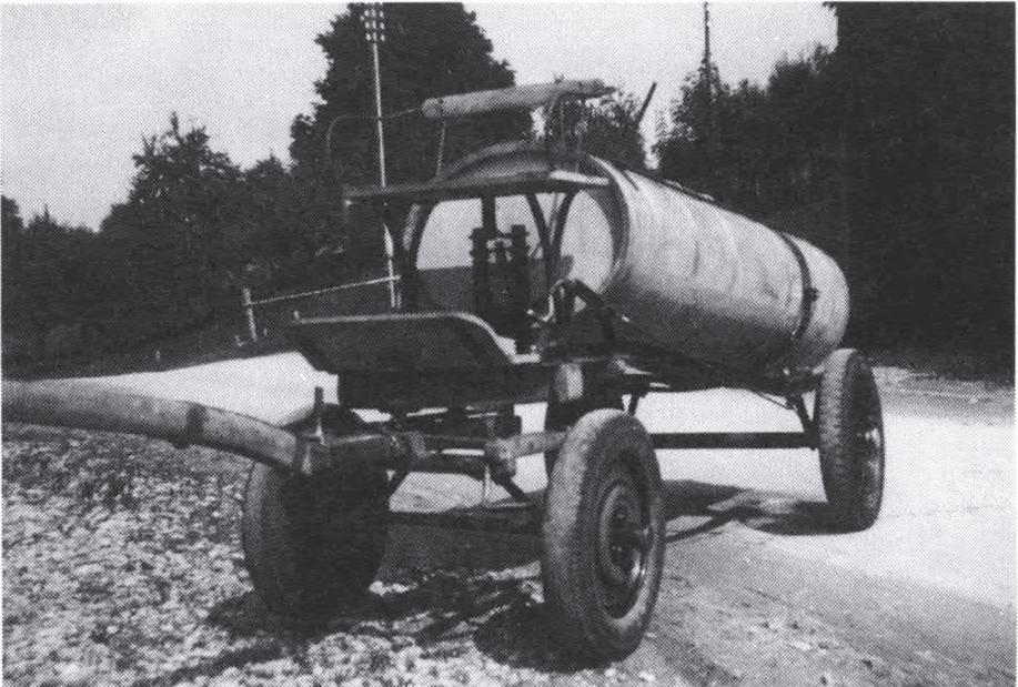
*Übergangsphase vom Pferde- zum Traktorzug: In einem ersten Fortschritt erhielten die Fahrzeuge in der Schmiede neue Achsen und Gummibereifung*
